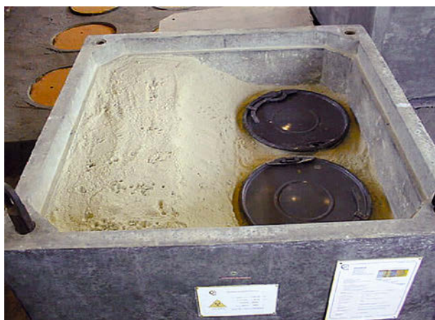
Рис. 1. Упаковка для захоронения РАО с использованием контейнера НЗК-150-1,5П
