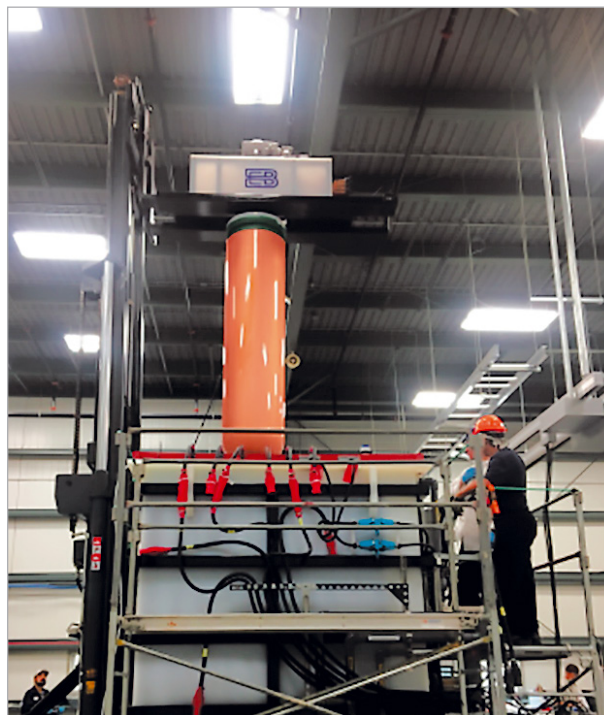
Рис. 2. Канистра для захоронения РАО с гальваническим покрытием
