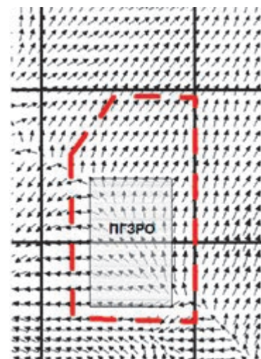
Рис. 2. Линии тока подземных вод в горизонтальной плоскости в районе пункта глубинного захоронения радиоактивных отходов (ПГЗРО) «Енисейский»
