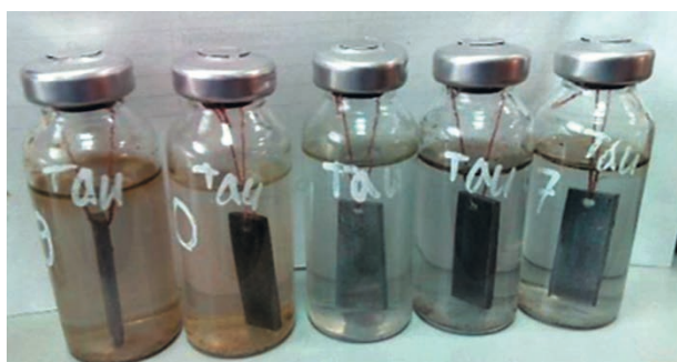
Рис. 2. Скорость коррозии стали Ст3 (мкм/год) при температурах 20 и 50 °С в различных условиях на 14 сутки. Система 1 — стерильная среда, анаэробные условия; Система 2 — стерильная среда, аэробные условия; Система 3 — вода участка «Енисейский», нативная микрофлора, без дополнительного стимулирования, анаэробные условия; Система 4 — вода участка «Енисейский», нативная микрофлора, анаэробное стимулирование в водороде; Система 5 — анаэробная обстановка, вода участка «Енисейский», микробное сообщество бентонита марки 10-й Хутор; Система 6 — вода участка «Енисейский», анаэробное стимулирование трегалозой; Система 7 — вода участка «Енисейский», анаэробное стимулирование сульфатом (500 мг/л) и водородом; Система 8 — смесь микробных сообществ подземной воды участка «Енисейский» и бентонита марки 10-й Хутор, анаэробное стимулирование сульфатом (500 мг/л) и водородом; R_i — скорость, мкм/год, R50 °C/R20 °C — отношение скоростей при температурах 50 и 20 °C (ось снизу)
