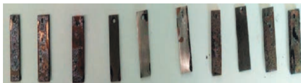
Рис. 1. Внешний вид корродирующих образцов стали Ст3
