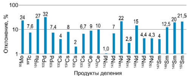
Рис. 7. Отклонения результатов расчетов по накоплению продуктов деления в образце 57 ОТВС ВВЭР-440 при уровне выгорания топлива 36 ГВт-сут/тU от экспериментальных значений
