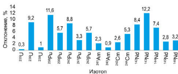
Рис. 8. Отклонения результатов расчетов содержания актинидов и продуктов деления в образце 581 от экспериментальных значений
