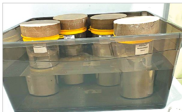
Рис. 5. Вид модельных систем (2) для имитации боковой поры/трещины в ходе проведения эксперимента
