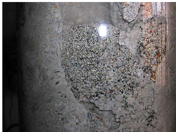
Рис. 4. Характерные каналы и полости, образующиеся в бентоните на ранней стадии его насыщения водой [32]
