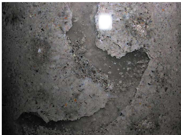
Рис. 4. Характерные каналы и полости, образующиеся в бентоните на ранней стадии его насыщения водой [32]
