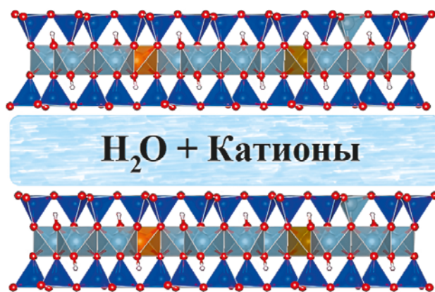
Рис. 2. Слоистая структура минерала монтмориллонита: синие тетраэдры – \text{SiO}_4 ; серые тетраэдры – \text{AlO}_4 ; серые октаэдры – \text{AlO}_6 ; оранжевые октаэдры – \text{MgO}_6
