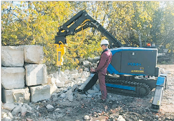
Рис. 6. Сравнительные испытания по разрушению ФБС
