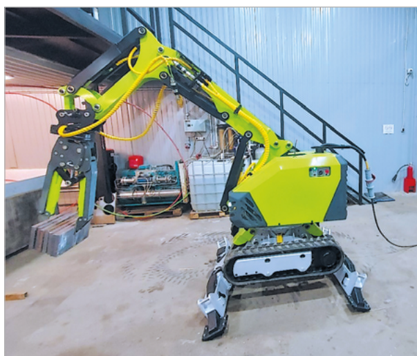
Рис. 2. Демонтажный комплекс Бетонолом-2000
