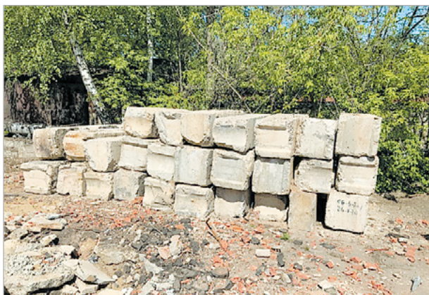
бетонные фундаментные блоки
