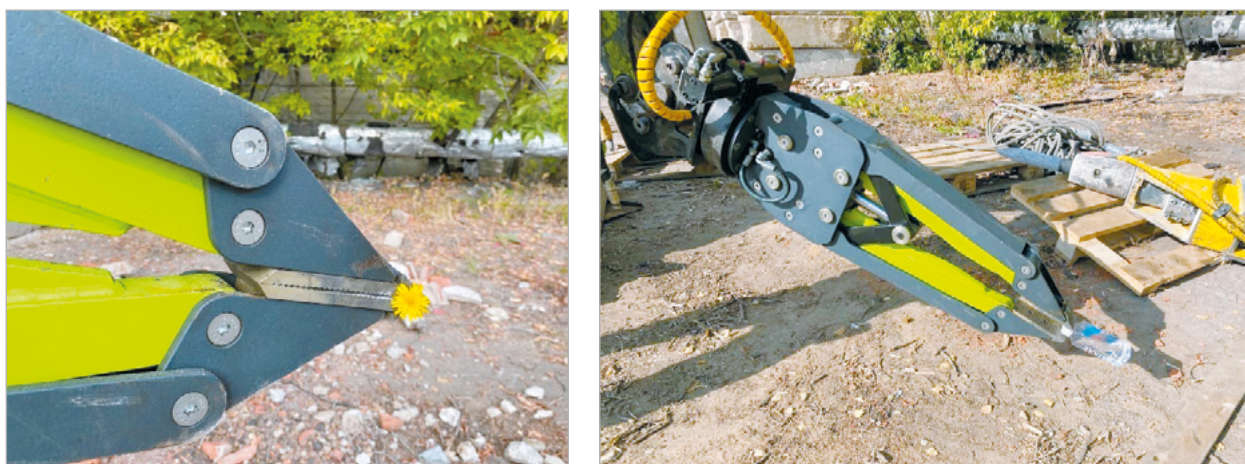
Рис. 8. Примеры тонких манипуляций с использованием гидравлического захвата
