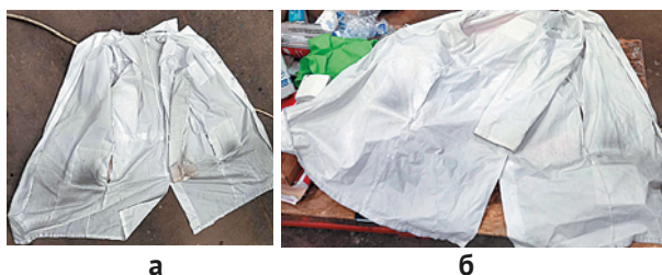
Рис. 5. Образец спецодежды, содержащий бытовые загрязнения, до (а) и после (б) проведения дезактивации
