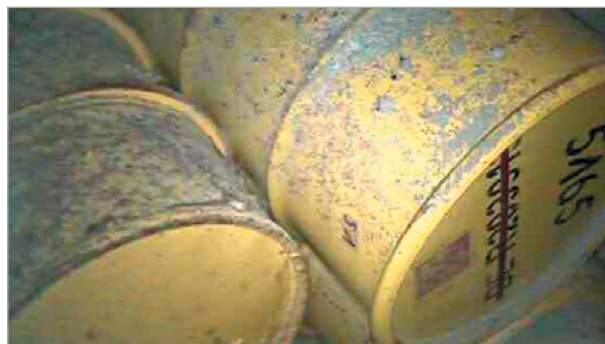
Рис. 4. Внешний вид бочек с РАО в камере № 12 шахты Ассе II [6]
