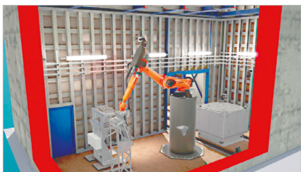
Рис. 5. Большой шестиосевой промышленный манипулятор внутри специализированного хранилища оболочек ядерного топлива (PFCS) в Селлафилде [11]
