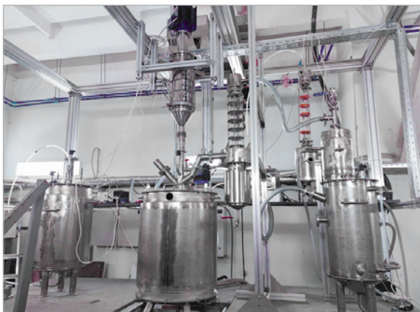
Рис. 4. Внешний вид макета установки остекловывания ЖРО на базе ИПГТК
