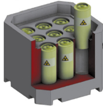
Контейнер НЗК с остеклованными РАО (вид в разрезе, без крышки)
