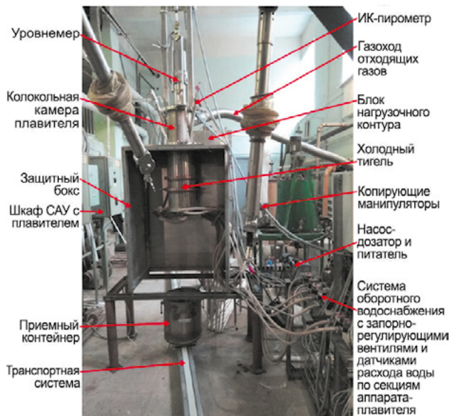
Рис. 1. Внешний вид установки остекловывания ЖРО с ИПХТ
